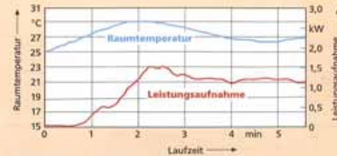
2 Kaltstart einer Toshiba Inverteranlage bei -15 °C Außentemperatur
