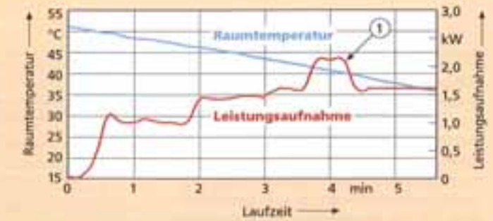
3 Warmstart einer Toshiba Inverteranlage bei 43 °C Außen- und 50 °C Innentemperatur
